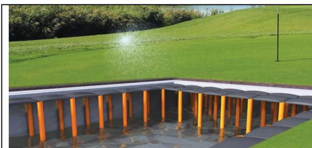
Mit Atlantis Elementen lassen sich beliebig große Regen und Wasserspeicher errichten die belast- und befahrbar sind. Die Wanne wird unterteilt; eine wird als weiße Wanne ausgeführt, der Überlauf hat Kiesboden zum Versickern und im 3. Teil befindet sich die Technik. Der Überlauf geht in den Kanal. Die Atlantis Elemente werden einbetoniert; die mit Beton befüllten Rohre dienen als Ständer.
