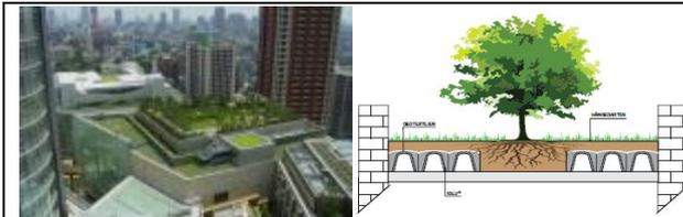
IGLU Green roof ist ein Konzept für grüne Dächer; Durch das Aufständern mit IGLU und Weglassen wo Bäume wachsen sollen wird Gewicht gespart und das Dach unterlüftet;
