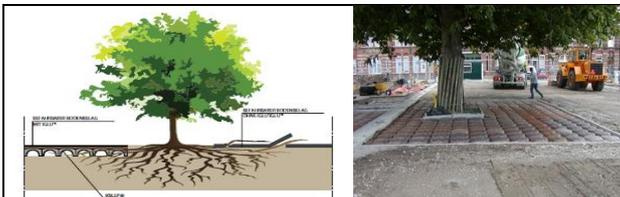
IGLU als Wurzelschutz; Werden rund um Bäume IGLU Elemente verlegt, dann verhindern diese das Aufbäumen von Wurzeln im Asphalt oder Beton - weil Wurzeln nicht durch luftige Räume wachsen sondern wieder umdrehen. Dadurch weniger Reparaturen und Unfallgefahr.
